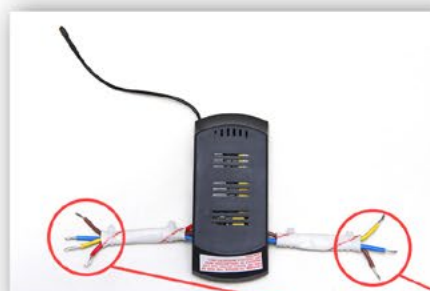
Отсоедините разъемы и зачистите провода приемника Telefon
