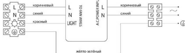
Соедините провода приёмника с вводными проводами, используя 3-х местную клемму (приобретается отдельно)
